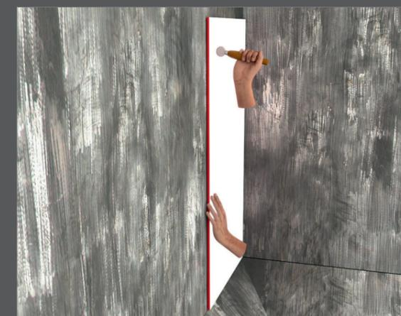
6. Danach mit einem Rändelroller über die Oberfläche gehen
